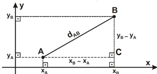
A distância entre os pontos A e B indicada por  $d_{AB}$  é calculada aplicando-se o teorema de Pitágoras no triângulo ABC:
